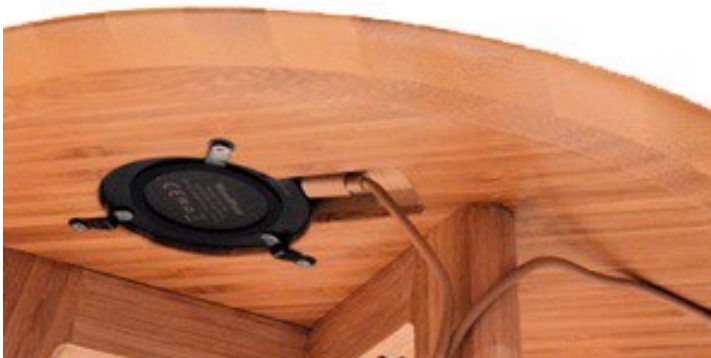
Figure D-1: vue de dessous de la base iO3 après intégration
